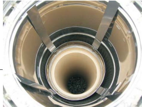
Profilrohr mit Abstandhalter in Aufsatz eingebaut
